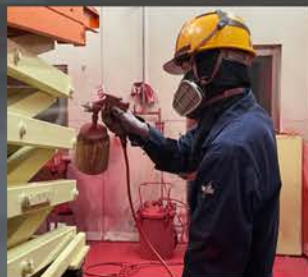
手吹き塗装作業
