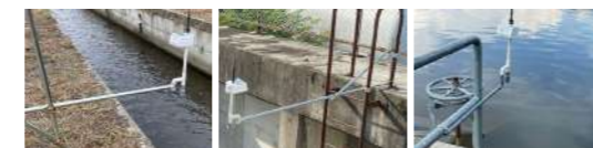
パイプを土手に打ち込み固定 ハシゴのパイプにクランプで固定 水門パイプにバンドで固定
